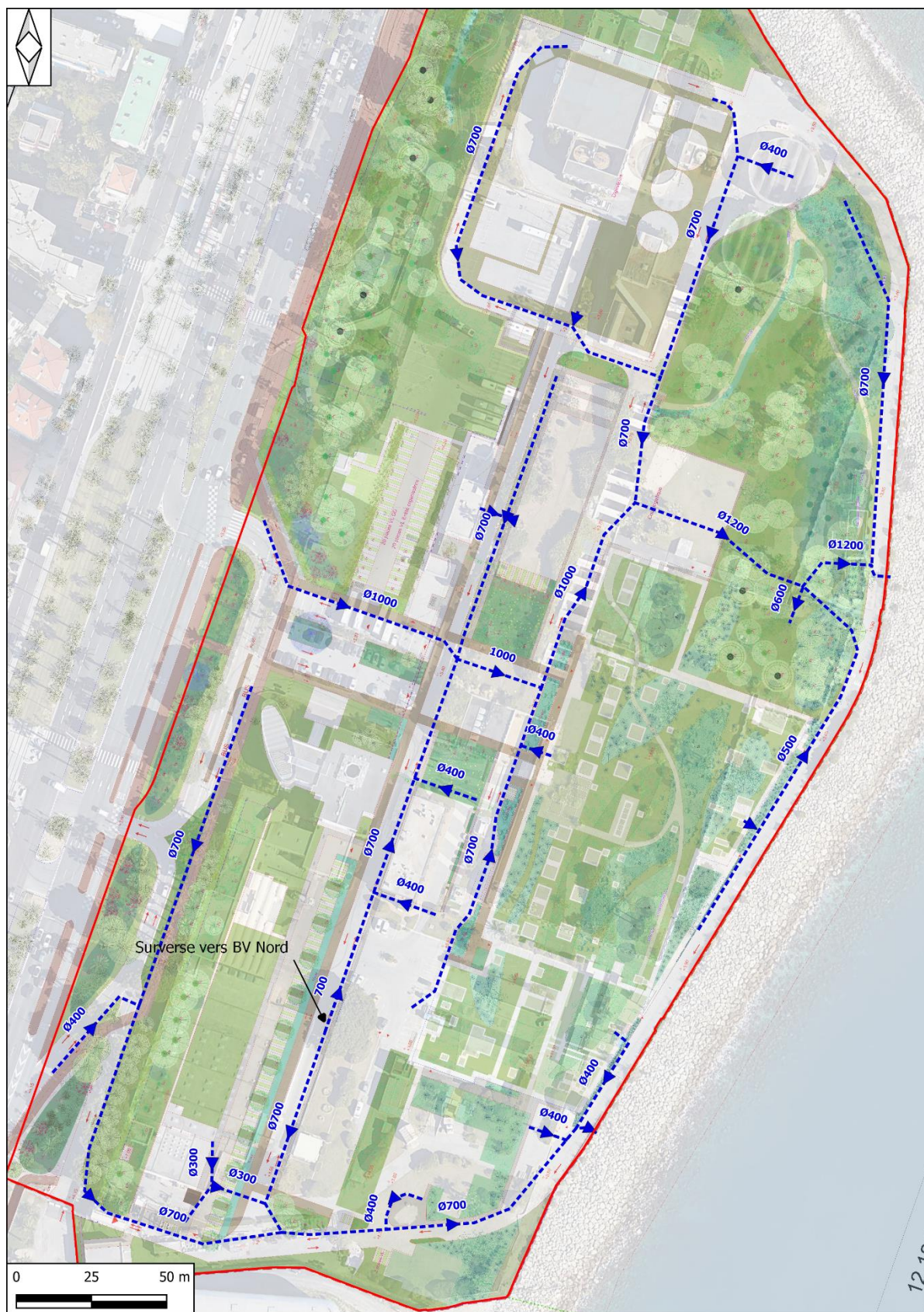
Illustration 6 – Réseaux de gestion des eaux pluviales mis en place dans le cadre du projet
